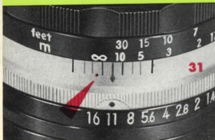
赤外線写真的撮影では焦点面が可視光の焦点面位置より幾分ずれますので、このずれだけ焦点面の位置を修正しなければなりません。
